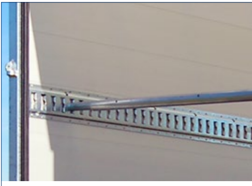
Extra gatenrail en spanstang • Extra Lochschiene und Spannstange Extra Cargorail and telescopic bar Rail de trou et tige de tension supplémentaire
